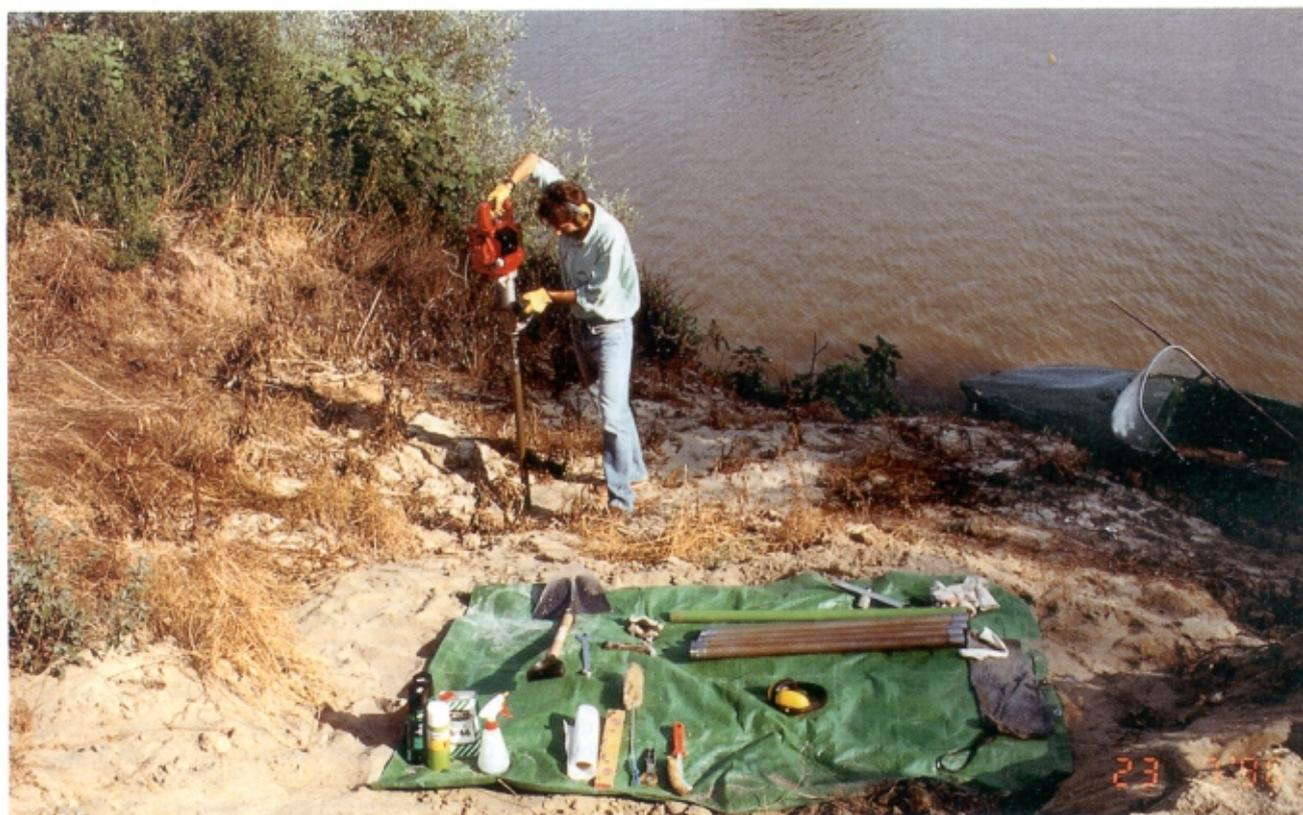
Fig. 3 - Il carotatore autoinguainante AF in azione con in primo piano l'attrezzatura di supporto.
