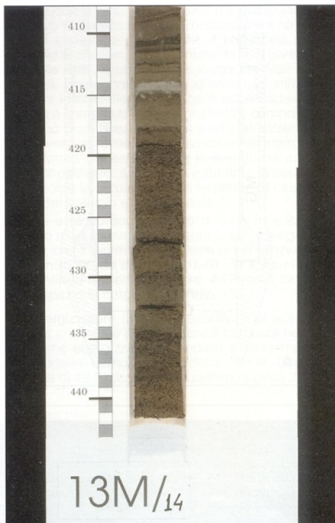
Fig. 6 - Esempio di campione già predisposto e sezionato per lo studio. Si noti l'estrema leggibilità stratigrafica del campione nel quale vengono preservati inalterati anche livelli millimetrici. Il livello grigio chiaro è un livello di tefra.
