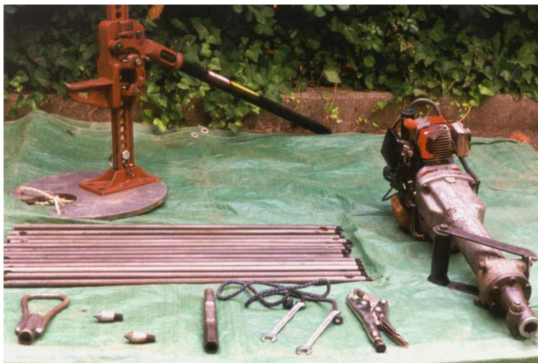
Fioretto - Attrezzatura completa Aste, teste, raccordo, gancio, estrattore, chiavi
